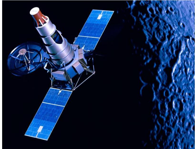
Lancé le 28 juillet 1964, **Ranger 7** suit une trajectoire d'impact lunaire et transmette des images à haute résolution de la surface lunaire durant les dernières minutes du vol, jusqu'à l'impact. Les caméras sont disposées en deux chaînes ou canaux distincts et autonomes avec alimentation, minuteries et émetteur séparés de manière à atteindre une plus grande fiabilité et la probabilité d'obtenir des images vidéo de haute qualité.
