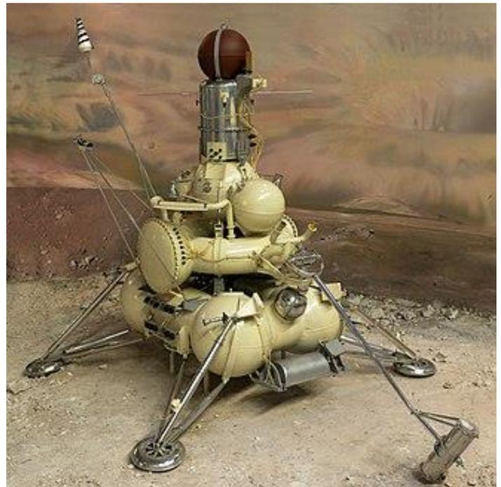
Le véhicule de retour est situé au-dessus de l'étage de descente. Cet engin de 520 kg (245 kg sans le carburant) est composé d'un compartiment d'équipement de forme cylindrique surmontant les trois sphères contenant le carburant et le moteur-fusée principal. Celui-ci (KRD-61) est du même type que le moteur de l'étage de descente mais sa poussée n'est pas modulable. Il fournit une poussée de 18,8 kN durant 53 secondes qui génère 2,7 km/s, suffisant pour échapper à l'attraction de la Lune.
