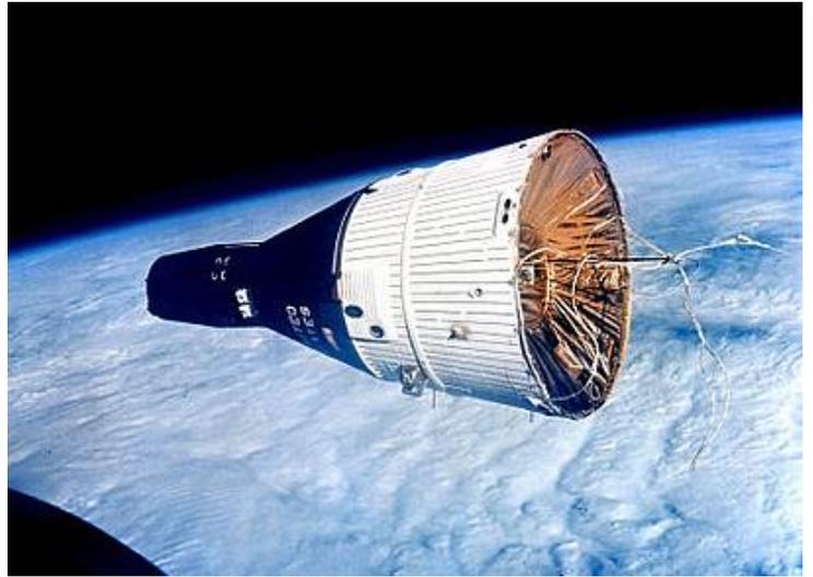
Le vaisseau Gemini, initialement une simple version améliorée de la capsule Mercury, se transforme au fur et à mesure de son développement en un vaisseau complètement différent de 3,85 tonnes (contre 1 tonne environ pour Mercury), capable de voler avec deux astronautes durant deux semaines. Le vaisseau est lancé par un lanceur Titan II, fusée de l'armée de l'air américaine reconverti en lanceur.
