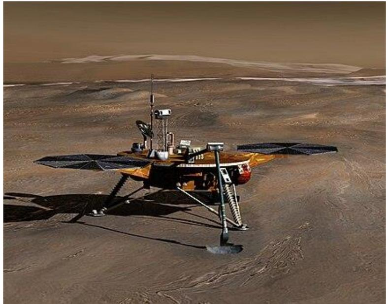
L'engin qui se pose sur le sol de Mars a une masse de 350 kg et dispose de plusieurs instruments (55 kg) comprenant deux petits laboratoires d'analyse chimique alimentés avec des échantillons du sol prélevés par une pelle télécommandée, des microscopes, des caméras et une station météorologique.
